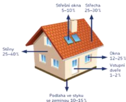
Obr. 32 Tepelné ztráty RD (zdroj: URSA CZ)
